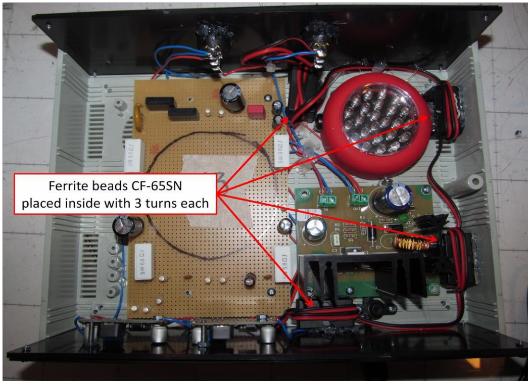
Perles de ferrite placées à l'intérieur avec 3 tours chacune (inscrit sur la photo) Perles de ferrite placées à l'intérieur du deuxième échantillon
