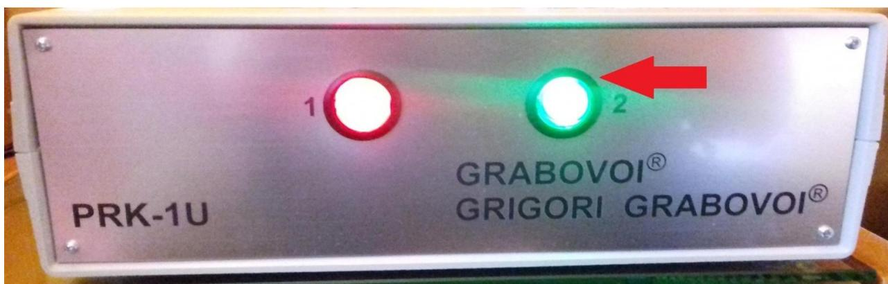
Afin de déterminer le mode de fonctionnement du dispositif à un moment donné, il suffit de regarder le bouton (2) de sélection des modes.
